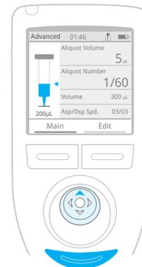
Drücken Sie die linke Taste **Hauptbildschirm** (Main) und wählen Sie **Manuell** (Manual). Bewegen Sie den Joystick nach oben, um mindestens 10 % des Nennvolumens der zu pipettierenden Flüssigkeit aufzunehmen. Drücken Sie dann die Auswurfaste unter dem Joystick. NanoRep fragt: „Spitze entleeren?“ (Empty tip?) Halten Sie die Spitze über den Flüssigkeitsbehälter und drücken Sie dann die linke Taste **Fortfahren** (Continue). Die Spitze wird entleert. Die Spitze ist nun vorgespült.
