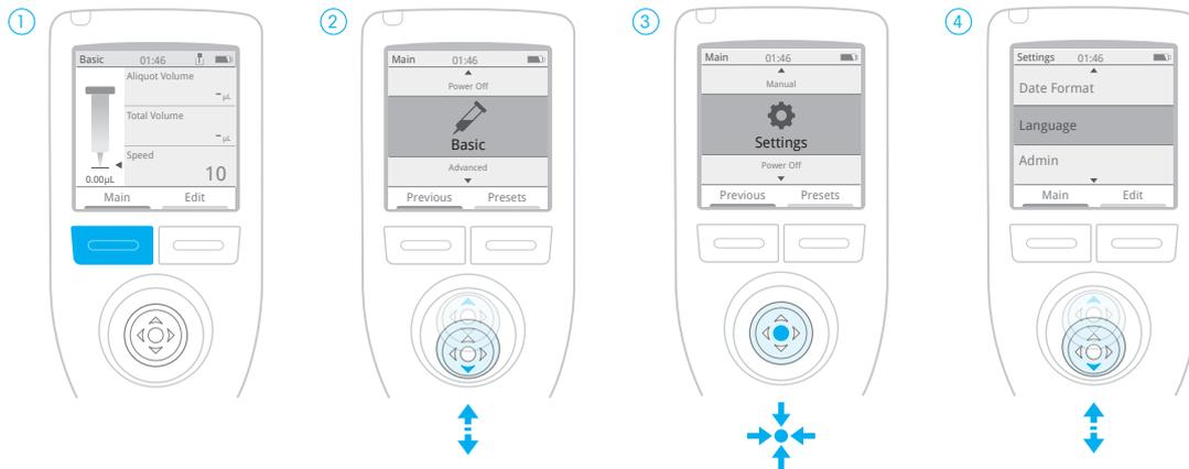
Drücken Sie eine der blauen Tasten, um die NanoRep einzuschalten. Es wird eine Begrüßungsanzeige eingeblendet, anschließend wird der Arbeitsbildschirm im Basic Modus angezeigt. Drücken Sie auf **Hauptbildschirm (Main)**.
